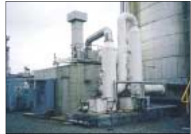
Fig 37. VOC 제거 열화수형 촉매연소 장치 (SKICO-REC)
